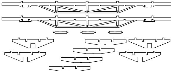
C.- Armar los refuerzos inferiores, que consta de dos largueros longitudinales, y cuatro transversales. También se pueden colocar los soportes de bogies, que encastran en los largueros y en el piso del vagón.
