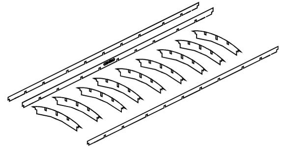
C.- Armar los refuerzos inferiores, que consta de cuatro tensores longitudinales, y dos transversales. También se pueden colocar los soportes de bogies, que encastran en los largueros y en el piso del vagón.
