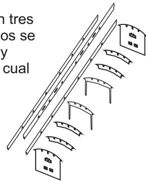
C.- Armar los refuerzos inferiores, que consta de cuatro tensores longitudinales, y dos transversales. También se pueden colocar los soportes de bogies, que encastran en los largueros y en el piso del vagón.
