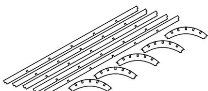
3) Ya armada la caja se puede presentar, la estructura del techo. La cual se puede pegar independiente de la caja del vagón.
