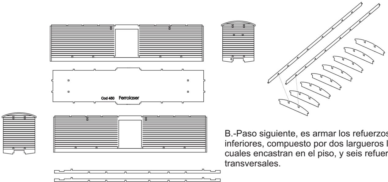
B.-Paso siguiente, es armar los refuerzos inferiores, compuesto por dos largueros los cuales encastran en el piso, y seis refuerzos transversales.
