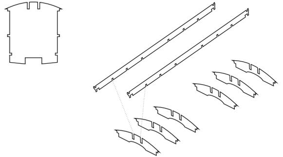
B.-Paso siguiente, es armar los refuerzos inferiores, compuesto por dos largueros los cuales encastran en el piso, y seis refuerzos transversales.
