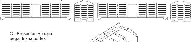
longitudinales y transversales del techo. distribuyendo, a aquellos que sirven de refuerzo interior del vagón.
