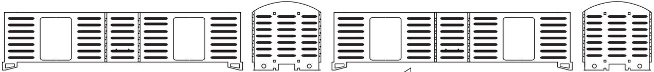
C.- Presentar, y luego pegar los soportes longitudinales y transversales del techo, distribuyendo, a aquellos que sirven de refuerzo interior del vagón.
