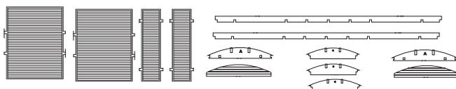
E) La estructura superior consta de do largueros, tres transversales curvo para la parte central, marcados con la letra C; dos transversales con la letra A para los frentes, y dos frentes. Entre los transversales A , B y C se colocan los cielo rasos, que le darán rigidez a la estructura.
