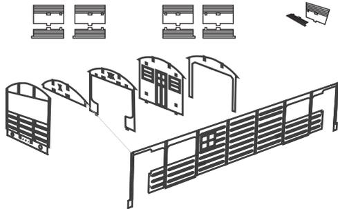
C) Entre los distintos paneles de los frentes, se colocan los cielorrasos, los cuales tienen diferentes encastes.
